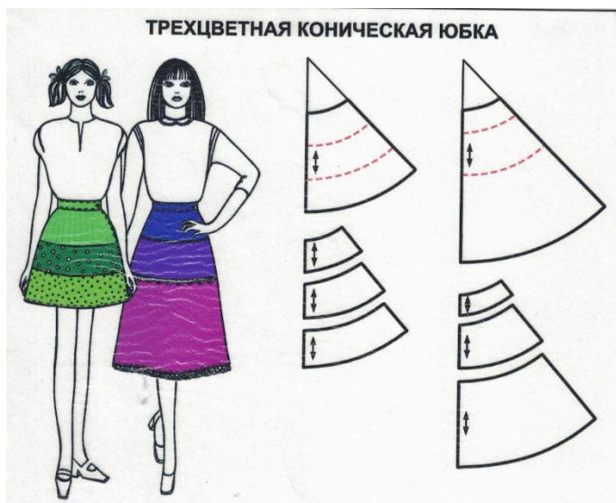
На готовый чертеж конической юбки наносят линии разрезов, делящих юбку на три полосы равной ширины или в любой произвольной пропорции.
