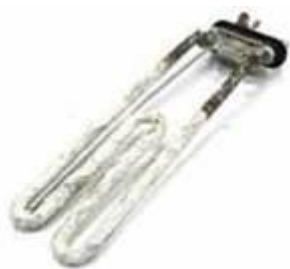
Мал. 74. Нагрівальний елемент, вкритий шаром накипу
