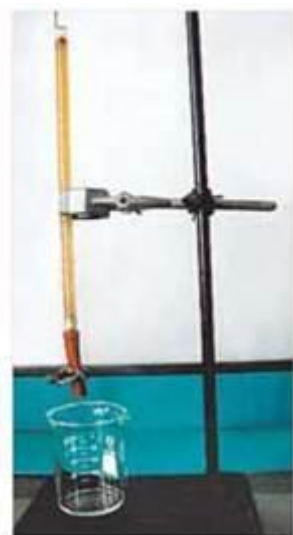
Мал. 75. Пом'якшення води в лабораторних умовах із використанням йонообмінної колонки
