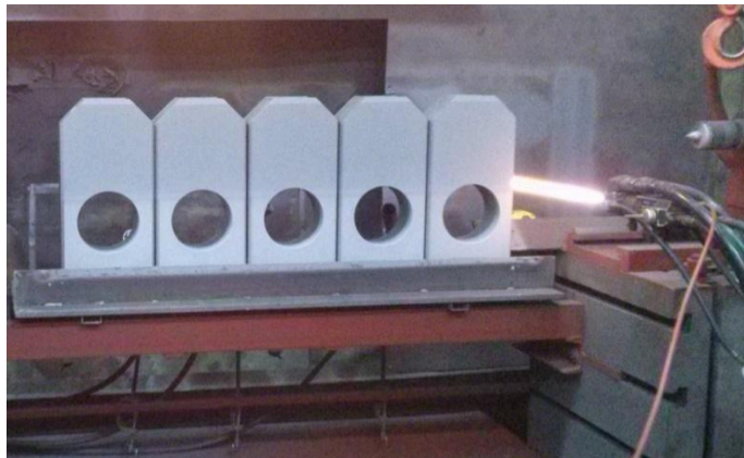
Fig. SEQ Ilustración \* ARABIC 3: Aplicación HVOF en válvula esclusas para petróleo
