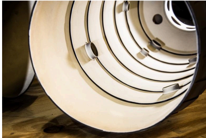
Fig. SEQ Ilustración \* ARABIC 2: TBC (thermal barrier coating) aplicación típica por Plasma para partes calientes de turbinas de combustión interna
