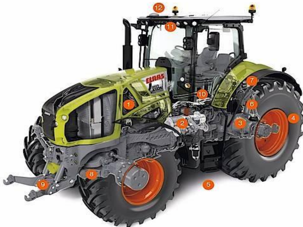
Рис. 3. Особливості будови сучасного трактора (на прикладі моделі AXION 950-920 CLAAS):
