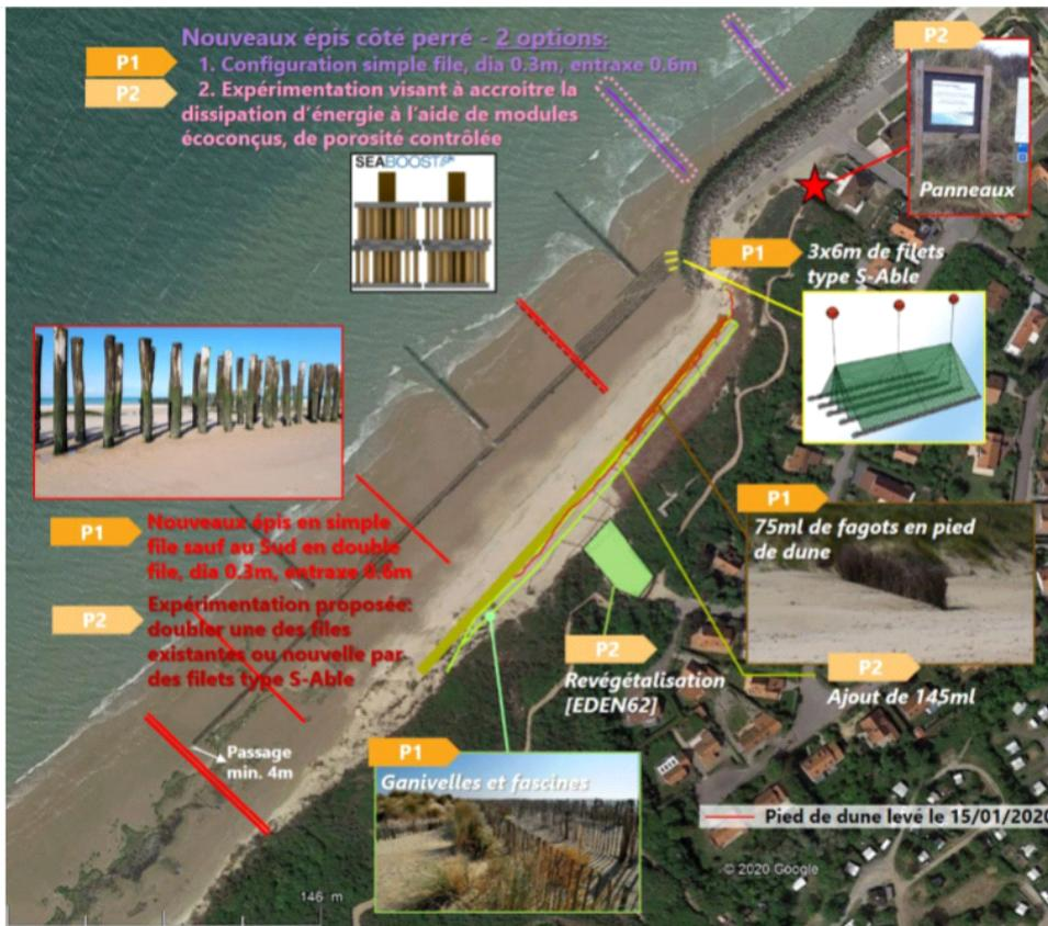
Figure 71: Interventions proposées sur le secteur Dune d'Aval - Sud perré, hors remontées de sable
