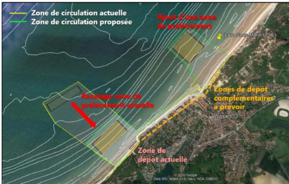
Figure 72 : Adaptations proposées pour les opérations de remontées de sable actuelles (AOT 2017-2022)
