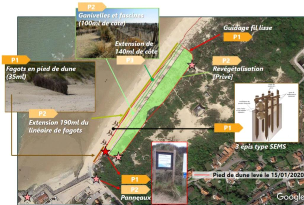
Figure 81: Interventions proposées sur le secteur Dune d'Amont, hors remontées de sable
