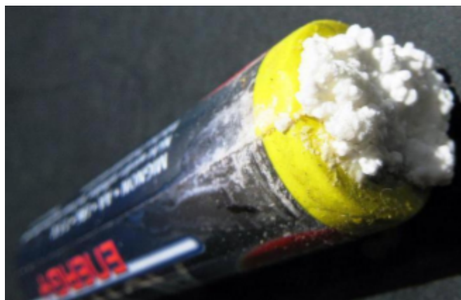
Фото 2 – Окисление отработанной батарейки
