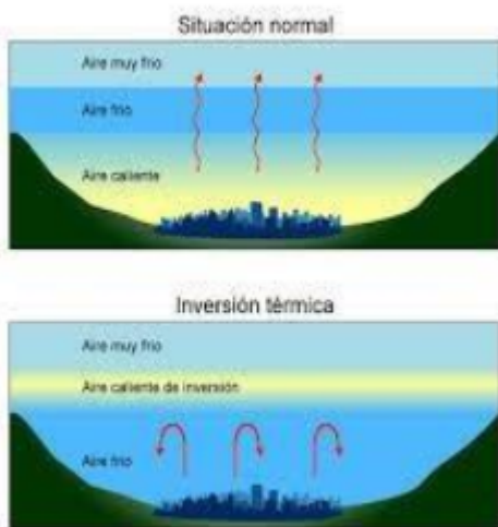
Figura 7. Gradiente negativo o "Inversión". En el gradiente vertical de temperatura, esta disminuye con la altura. Una inversión es un aumento de temperatura con altura, es decir, un gradiente positivo. Aquí se muestra una inversión de superficie y una inversión en altura.
