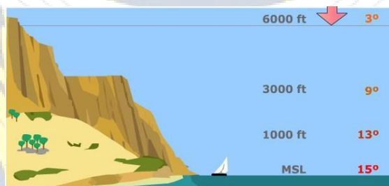
Fig.1.1.2 - La temperatura cambia con la altura.
