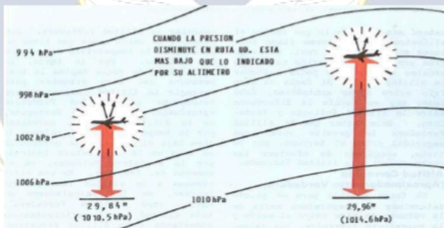
FIGURA 15. Cuando vuela desde alta a baja presión sin ajustar su altímetro está perdiendo altitud verdadera.
