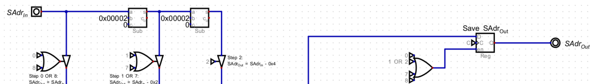
Abbildung 36: Vollständige Schaltung zur Ausgabe der aktuellen Stack-Adresse
