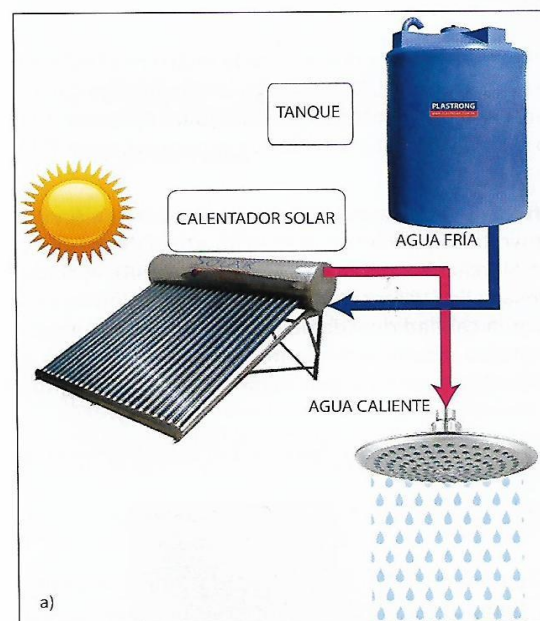
Figura 6.20. Sistemas de calentamiento solar activo. a) A la izquierda: sistema de calentamiento de agua b) A la derecha: horno solar
