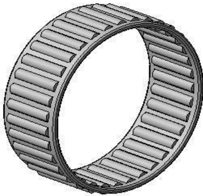
Рис. 2.10. Голчатий підшипник без зовнішнього та внутрішнього кілець
