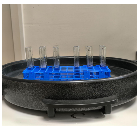
Slika 9. Uzorci pripravka vode s različitih lokacija s područja Međimurske županije s otopinom metilenskog modrila u vodenoj kupelji Figure 9. Water sample preparations from different locations in Međimurje County with methylene blue solution in a water bath
