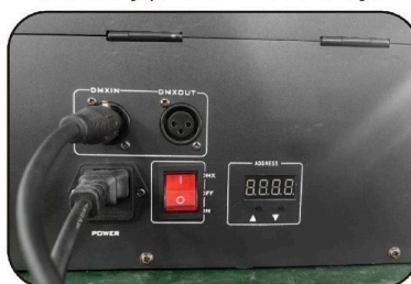
4. conecte el cable de alimentación, encienda el interruptor y conecte el control dmX.
