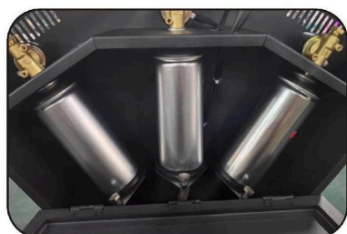
3. L'embouchure de la bouteille d'huile de pulvérisation est alignée avec l'interface de la machine
