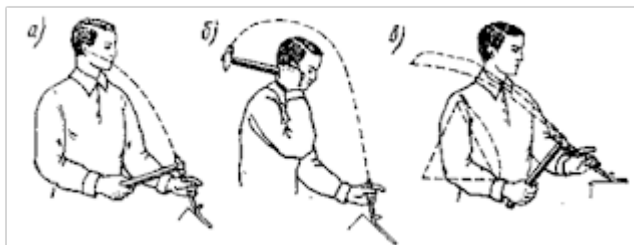
Мал. 5.5. Рух (розмах) молотка: а – при кистьовому ударі, б – при ліктьовому ударі, в – при плечовому ударі
