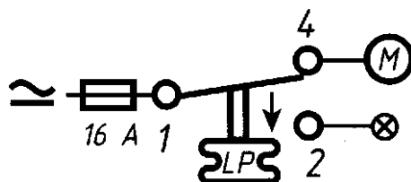
Рисунок 8. Схема срабатывания контактов термостата КР
