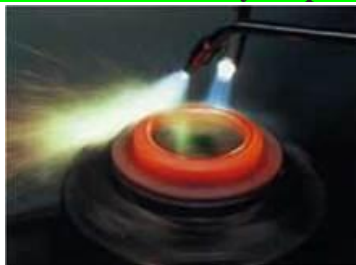
Мал. 4. Використання етину для нанесення захисного покриття на металевий виріб
