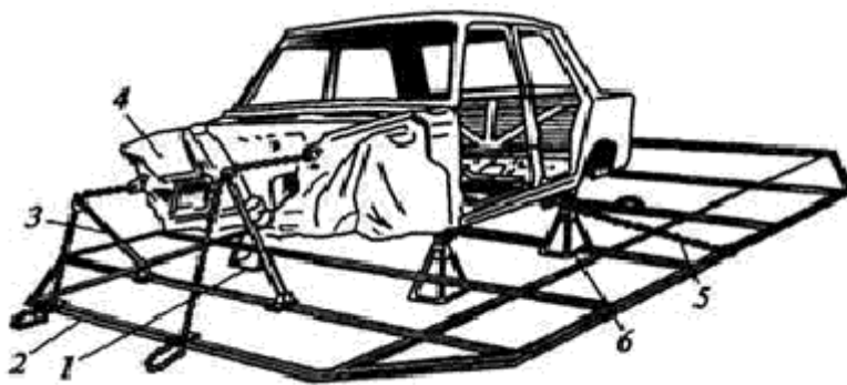
Рис.3.Стенд для правки кузова легкового автомобіля:
