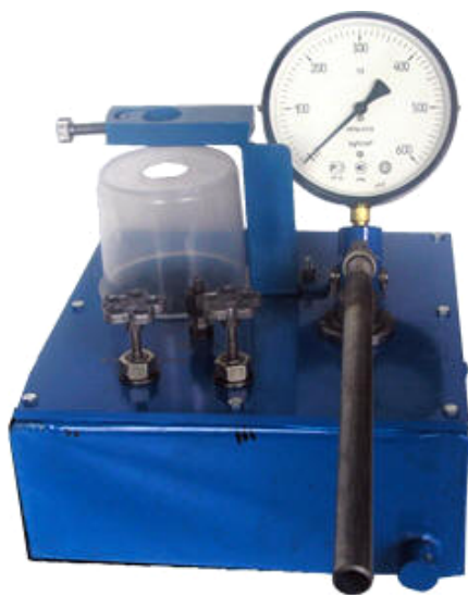
Рисунок 113. Стенд для випробування і регулювання форсунок ЕДС-СДФ-1.
