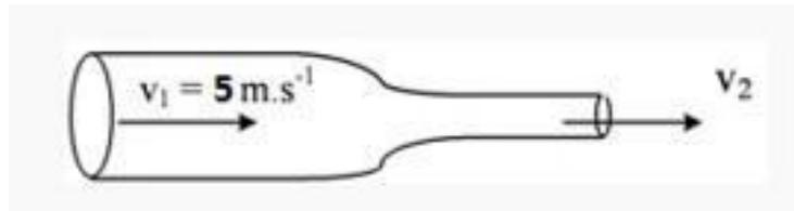
Fluida mengalir pada pipa seperti gambar di atas. Jika kecepatan aliran fluida pada penampang besar 5 m/s. Berapakah kecepatan aliran fluida pada penampang kecil jika diameter penampang besar dua kali diameter penampang kecil
