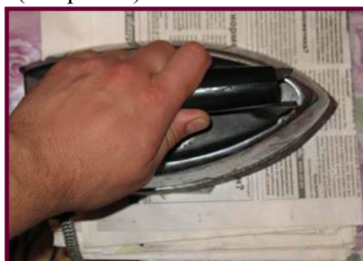
Рис. 7 Проглаживание утюгом печатной платы на текстолите
