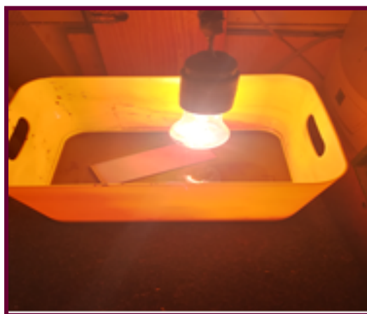
Рис. 11 Процесс травления в растворе хлорного железа
