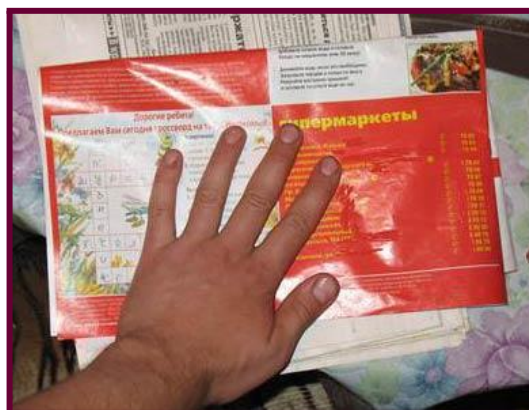
Рис. 8 Проглаживание руками печатной платы на текстолите
