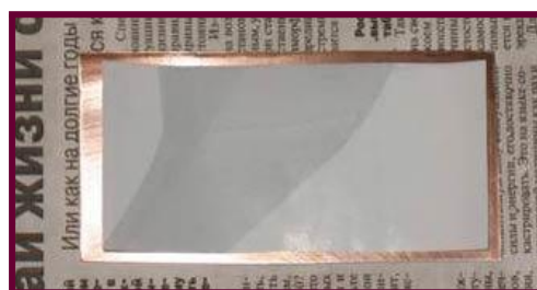
Рис. 6 Размещение печатной платы на текстолите
