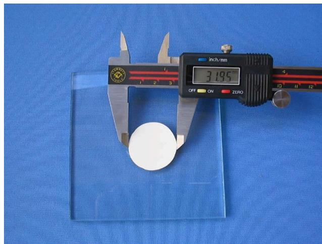
FIGURA 2 - Mensuração do disco de cimento com paquímetro eletrônico digital Starrett.
