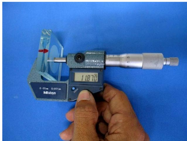
FIGURA 4 - Mensuração da espessura das placas contendo o cimento.
