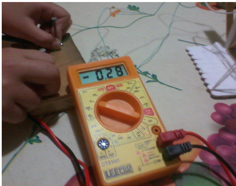
Figura 3: O multímetro constando a quantia de energia gerado com o projeto .
