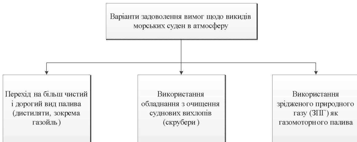
Рисунок 2 – Варіанти задоволення вимог щодо вмісту оксидів сірки, азоту та вуглецю, а також твердих частинок у викидах морських суден
