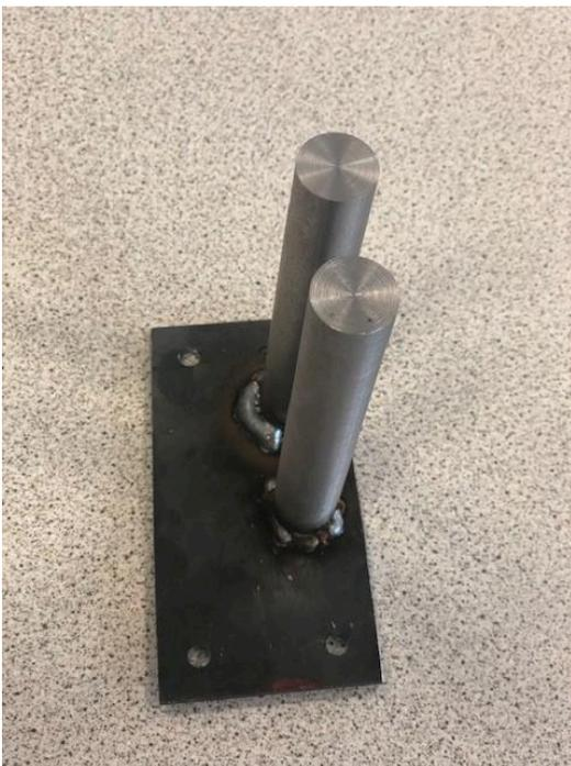
Pour effectuer la conception de notre support nous avons effectué un soudage de type MIG (Metal inert Gaz) et choisi l'acier comme matière de notre pièce afin d'avoir un soudage plus facile à réaliser.
