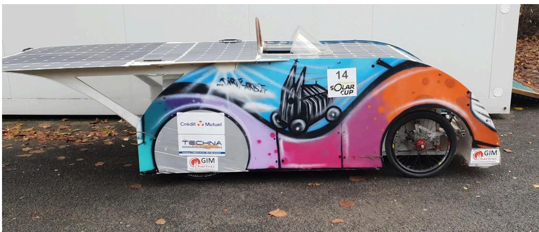
L'accès aux roues arrières du proto 1 est bloqué par les panneaux latéraux. La solution est de découper la partie de la coque bloquant l'accès aux roues et de mettre en place un système permettant de rendre amovible la partie découpée (de pouvoir l'enlever et la remettre à volonté).
