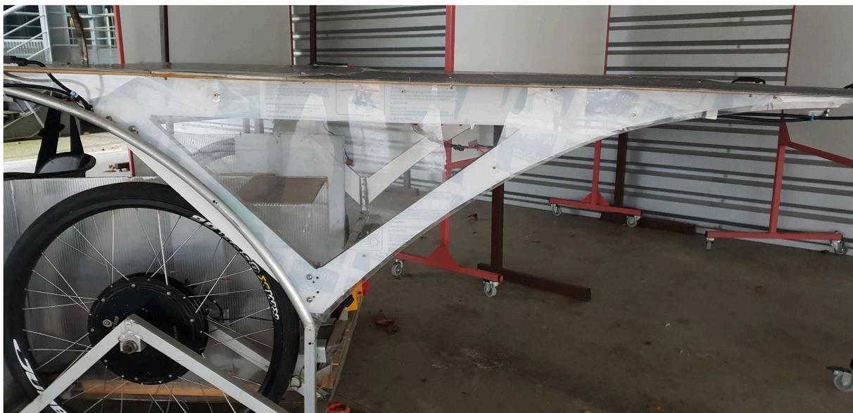
La partie sous les panneaux solaires est faite en contreplaqué (bois), tout ceci est lié ensemble par des barres en aluminium et des équerres. Nous avons démonté l'ensemble panneaux et prolongement panneaux afin de les peser. Nous avons donc un poids de 20 kg pour cet ensemble, ce qui peut sans doute être diminué par l'utilisation d'autres matériaux comme de l'aluminium. Une esquisse a été faite mais aucune solution concrète n'a été trouvée à ce jour.
