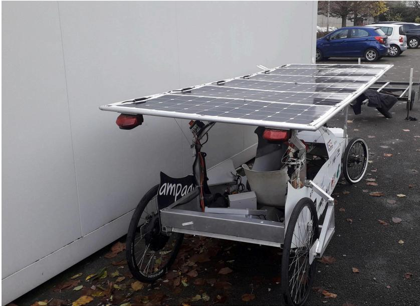
Le travail du groupe 3 qui est en charge de la partie électrique nous a aidé à diminuer le poids. En repensant le câblage du prototype 2, ils ont réussi à réduire le poids de 1 Kg soit 10% de notre objectif.
