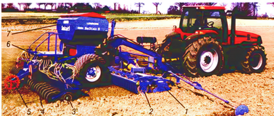
Рис. 3.1.8. Агрегат із сівалкою «Солітер-9»: 1 – ротаційна борона; 2 – котки; 4 – ролики-ущільнювачі; 5 – лічильне колесо; 6 – розподільник насіння; 7 – насіннєвий бункер
