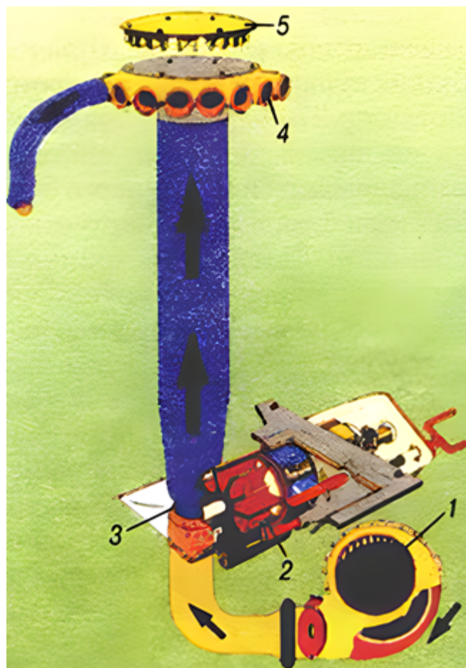
Рис. 3.1.6. Дозувальний пристрій і розподільник: 1 – вентилятор; 2 – дозувальний пристрій; 3 – насіннепровід; 4 і 5 – розподільники
