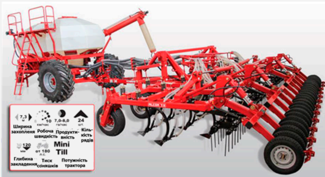
Рис. 3.1.9. Посівний комплекс ALCOR 7.5
