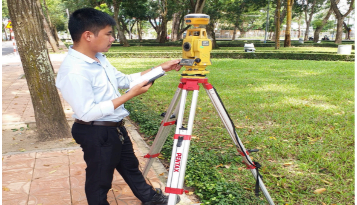
Hình 3. 18. Đặt máy toàn đạc điện tử có tích hợp máy định vị GNSS
