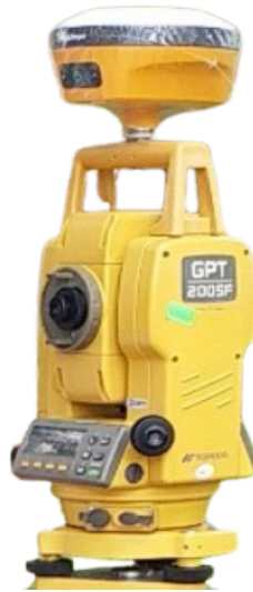
Hình 3. 4. Máy toàn đạc điện tử đã được tích hợp với máy định vị vệ tinh
