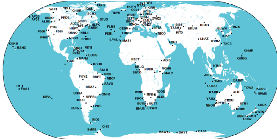
Hình 2. 8. Hệ thống trạm tham chiếu liên tục GNSS mạng lưới IGS
