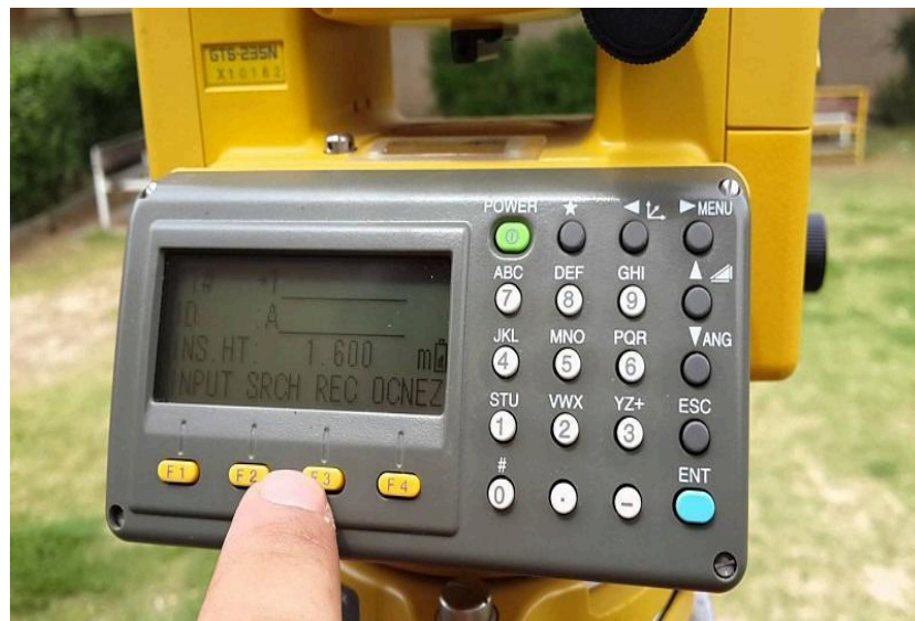
Hình 2. 23. Giao diện bàn phím chuẩn của máy toàn đạc điện tử Topcon GTS-239N
