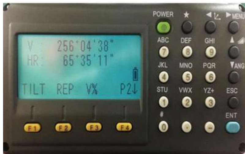
Hình 2. 29. Màn hình thiết lập trạm máy
