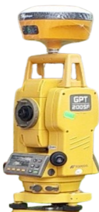
Hình 3. 17. Thiết bị đo đạc tích hợp máy định vị GNSS với máy toàn đạc
