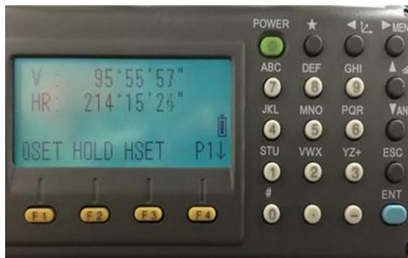
Hình 2. 30. Màn hình thiết lập điểm trạm máy nhập trực tiếp
