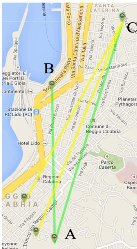
Il nodo della figura a sinistra, possiede una sola antenna e si tratta del punto A nella mappa a destra. Il nodo A è però connesso sia a B che a C. Questo comporterà una diminuzione delle prestazioni del nodo (perché dovrà comunicare con due in contemporanea) e il rischio che se si dovesse rompere anche la comunicazione tra B e C verrebbe interrotta.
