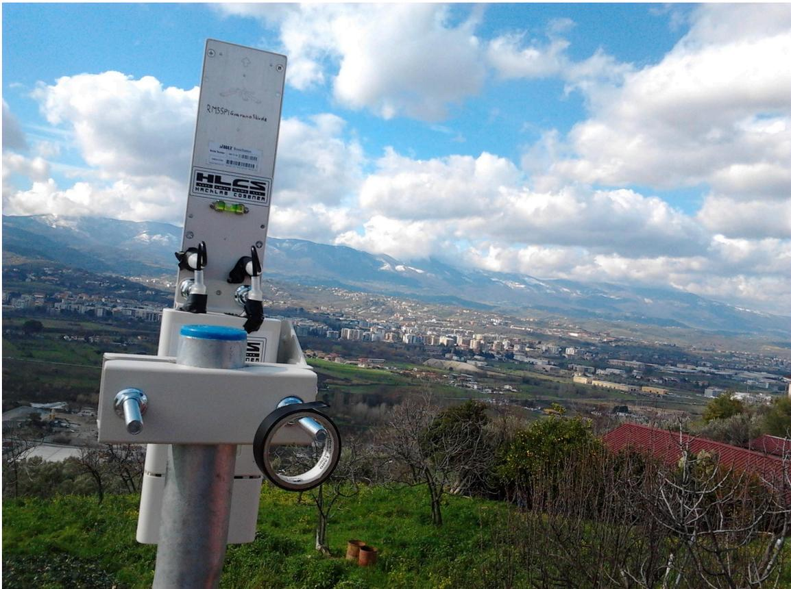
Procediamo a fare il login sugli apparati, via interfaccia web o SSH, a seconda delle nostre capacità e preferenze, verifichiamo che la nostra antenna si è associata (termine tecnico che indica lo stabilimento di un collegamento wireless) al nodo a cui vogliamo collegarci.
