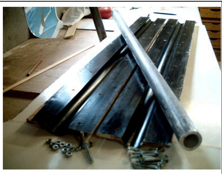
Les fourreaux de clé, normal comme d'hab.au tour de la clé avec du papier sulfurisé (pâte à tarte)avec les écrous à griffes pour le serrage des ailes, (Denis,t'as une idée sur la longueur des vis?)Bien assez rigolé il faut découper les ailes maintenant.....
