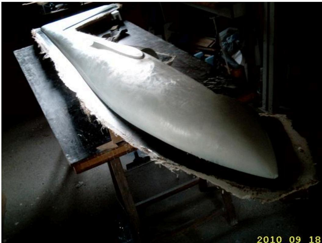
Reste à faire la seconde, le plan de joint est retiré, on stratifie directement sur la première coque (qu'il ne faut surtout pas démouler entre temps).
