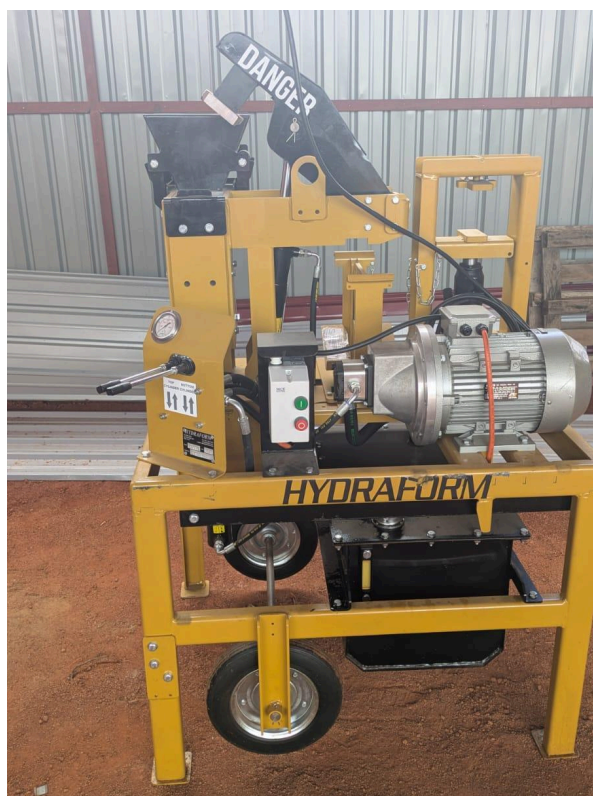
Macchina per fabbricare blocchetti (terra rossa e cemento)
