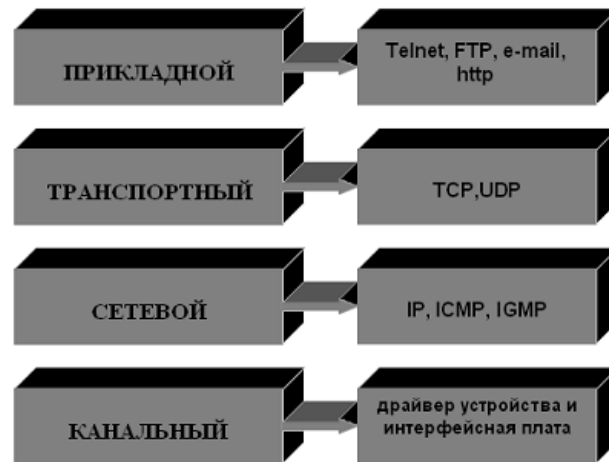
Рисунок 2. Четыре уровня протоколов TCP/IP
