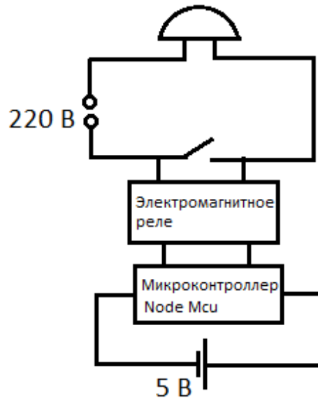
Схема 4.3 – управление временем с помощью NodeMcu
