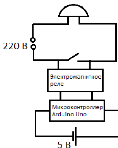
Схема 4.1 – управление временем с помощью ArduinoUno
