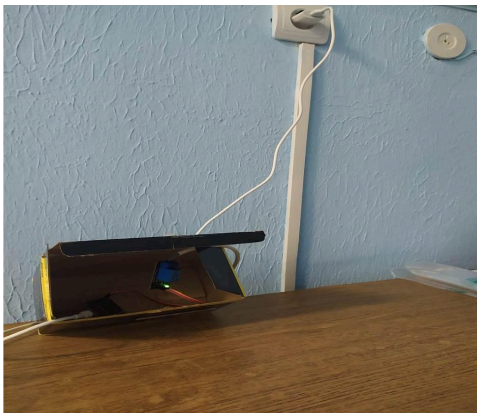
Фото 3. Подключенное устройство управления школьным звонком с помощью Node Mcu
