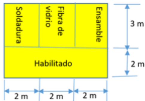
Figura 6. Layout de distribución de áreas para los procesos de fabricación.
