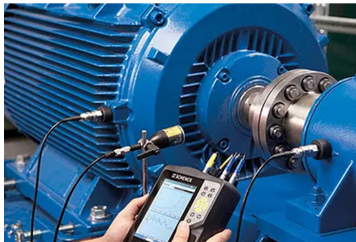
Figura 2.1 Medição de vibração em motor elétrico e medição do ruído emitido pelo acoplamento existente no sistema. Fonte: [Di Cocco et al. 2013]
