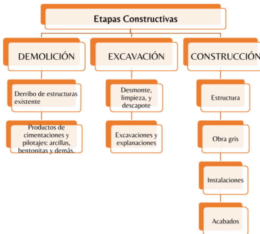
Ilustración 46 Etapas constructivas RCD
