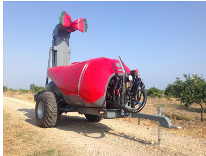
Şekil 2. Kuleli tip püskürtme ünitesine sahip yardımcı hava akımlı bahçe pülverizatör modelleri
