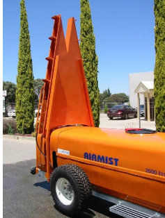
Şekil 2. Kuleli tip püskürtme ünitesine sahip yardımcı hava akımlı bahçe pülverizatör modelleri
