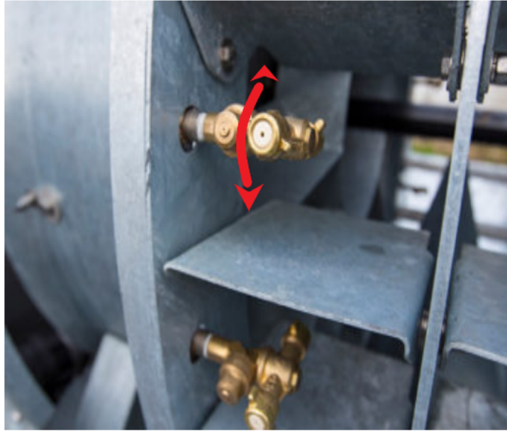
Şekil 9. Memelerin bağlantı noktasından ağaç tac yüksekliğine göre yönlendirilme seçeneği
