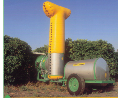
Şekil 2. Kuleli tip püskürtme ünitesine sahip yardımcı hava akımlı bahçe pülverizatör modelleri
