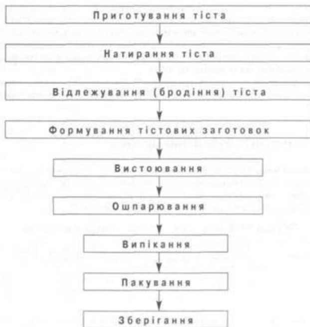
Рис. 11.4. Технологічні операції виготовлення бубличних виробів
