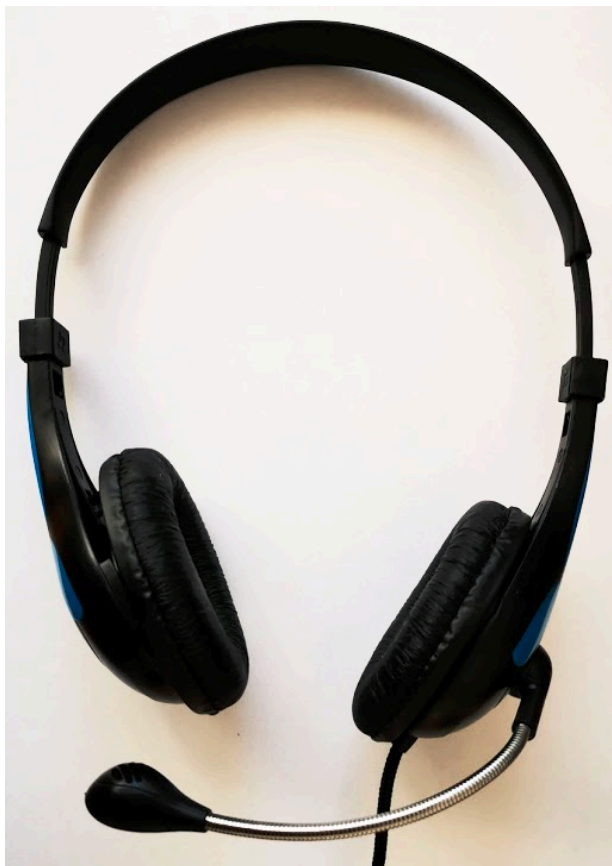
Rys. 1.4. Taki mikrofon (na pałaku) będzie działał poprawnie w złych warunkach akustycznych, bo jest w optymalnym miejscu: w stałej (niezależnej od ruchów głowy), małej odległości od ust, ale nie przed nimi (dzięki temu nie jest wrażliwy na głoski wybuchowe i dmuchanie).
