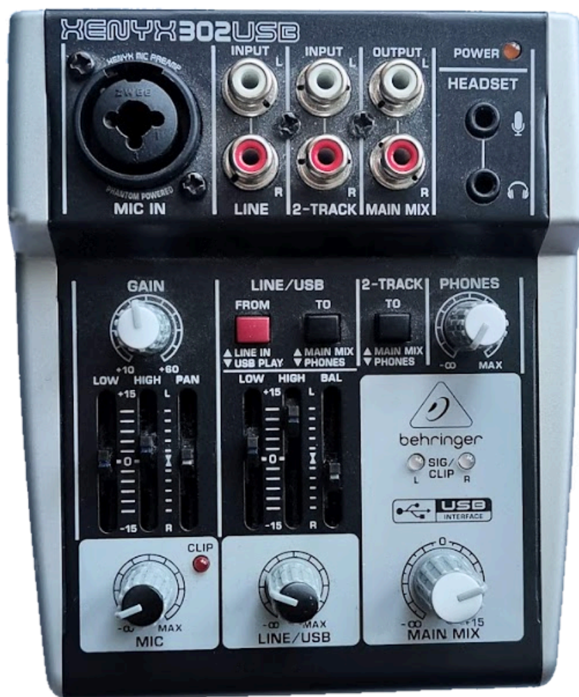
Rys. 4.1. Mikser Behringer XENYX 302 USB. Tani (poniżej 200 PLN), mały (46 x 114 x 136 mm), bardzo mobilny mikser. Jedno złącze USB do połączenia z komputerem zapewnia jednocześnie wejście i wyjście cyfrowe oraz zasilanie. Można jednocześnie przyłączyć tylko jeden mikrofon (miniJack, Jack lub XLR, w tym także wymagający zasilania Phantom). Wejścia i regulacje są widoczne na zdjęciu.
