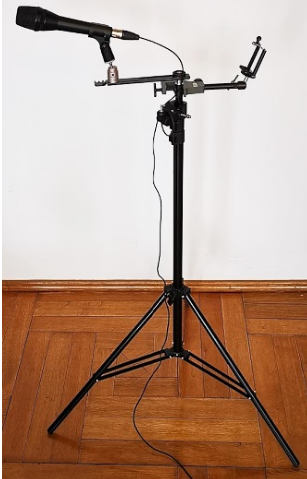
Rys. 1.2. Zaimprovizowany, ale działający sensownie statyw dla mikrofonu typu "wokal": wysoki statyw podłogowy (tu: do światła) eliminuje przenoszenie hałasów z blatu stołu i nie zajmuje miejsca na stole, wysięgnik fotograficzny z regulacją położenia pozwala ustawić mikrofon w pobliżu ust, mikrofon silnie kierunkowy (tu: superkardioidalny) eliminuje hałasy otoczenia i pogłos pomieszczenia.
