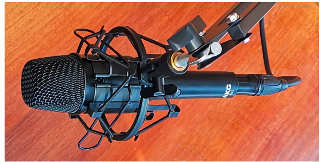
Rys. 1.3a. Komplet do nagrywania/przesyłania dźwięku podczas pracy oburęcznej przy stole. [1] Regulowany statyw teleskopowy. [2] Koszyczek na mikrofon (zawieszony na cienkich pasmach gumy) eliminuje przenoszenie hałasów z blatu stołu. [3] Mikrofon (do pracy jednoosobowej raczej kierunkowy). [4] Pop-filter (filtr chroniący przed hałasem ze strony wydychanego powietrza, np. przy głoskach p, b, t).
