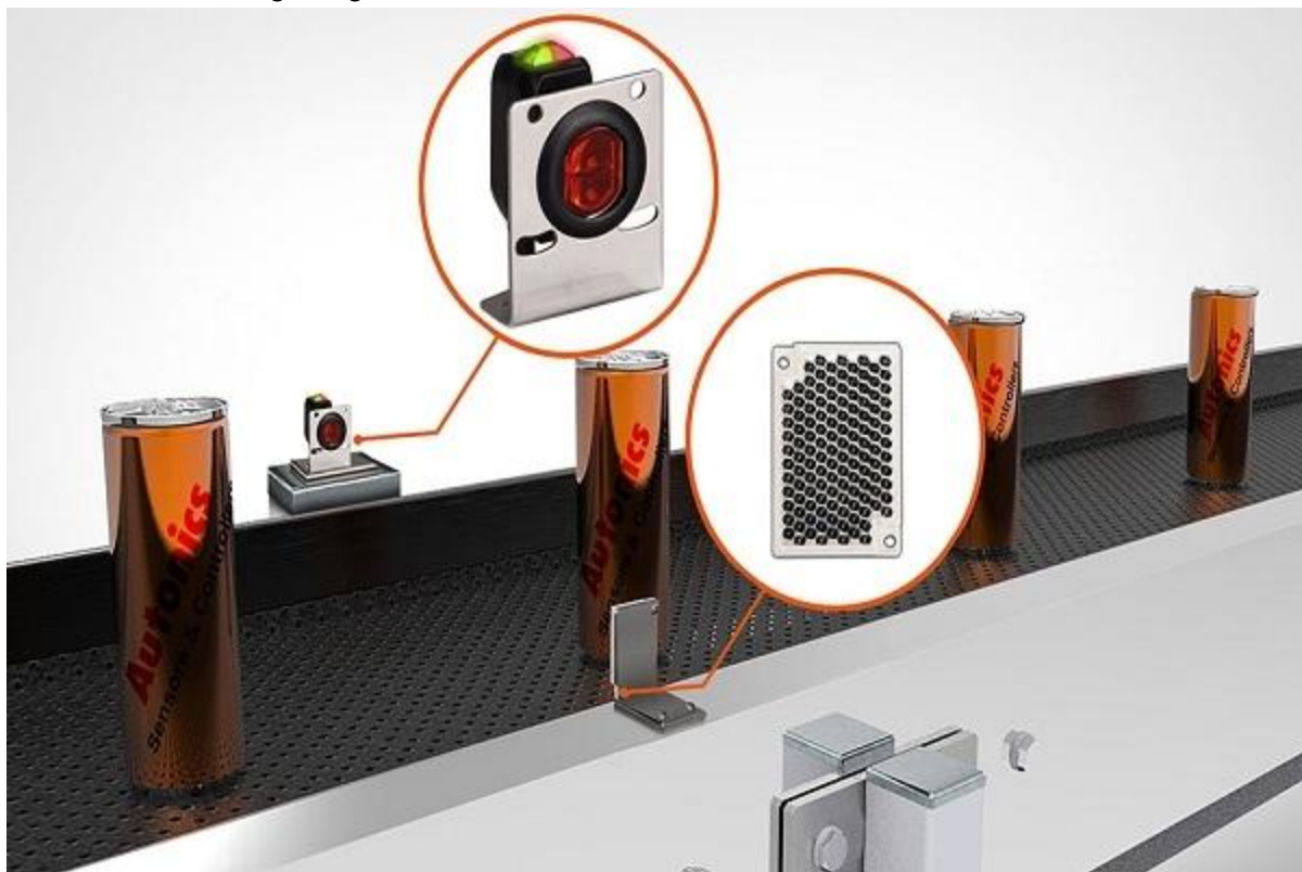
Hình 2: Ứng dụng cảm biến quang trên băng chuyền lon đồ uống
