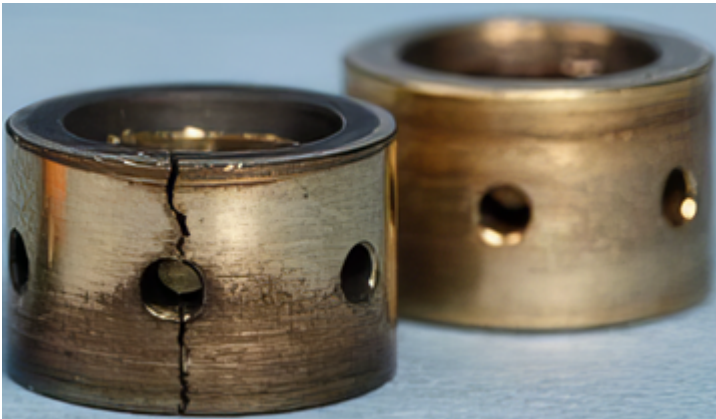
Рис. 3.54. Характерні несправності турбокомпресора
