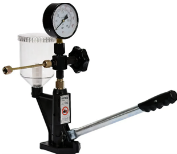
Рис. 3.91. Стенд для перевірки та регулювання форсунок УАТО УТ-72793 (КИ-562):
