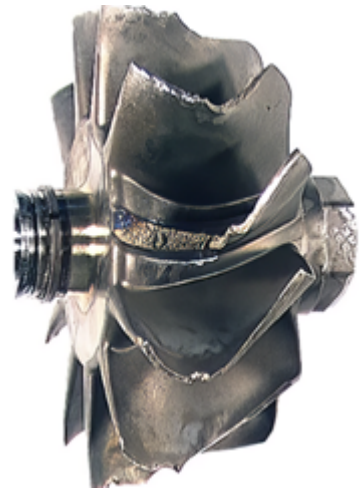
Рис. 3.54. Характерні несправності турбокомпресора
