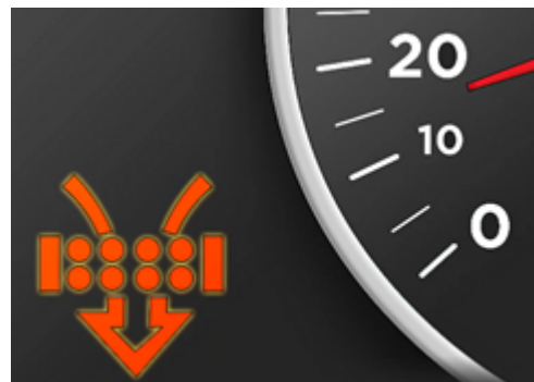
Рис. 3.66. Датчик засміченості повітроочисника дизельного двигуна
