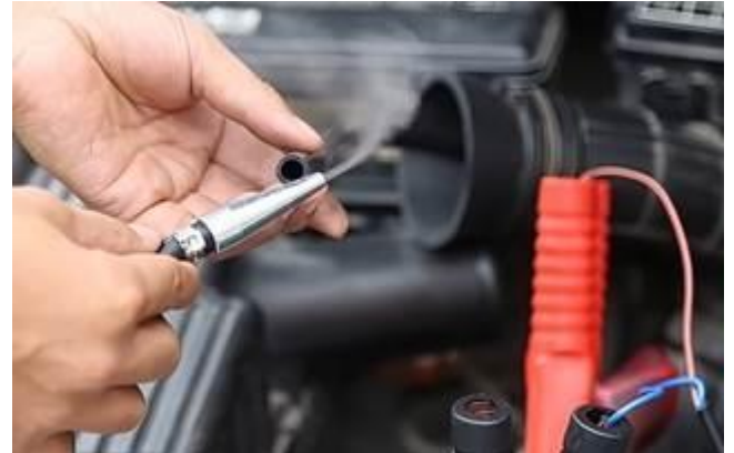
Рис. 3.64. Димогенератор JTC 6856 для перевірки щільності повітроочисника і впускного тракту
