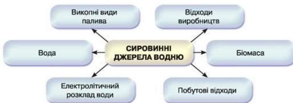
Рис. 75. Схема сировини для добування водню
