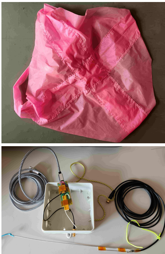
2. ábra. Ejtőernyő prototípus (bal), földi állomás (jobb) antennával, USB -s véggel.
