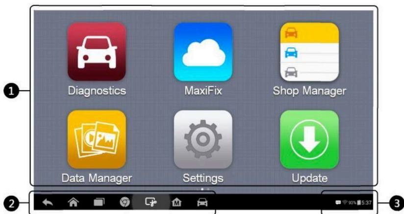
1 - кнопки додатків, 2 - показчик і кнопки навігації, 3 - значки станів Рисунок 1.16 - Робоче меню сканера MaxiDAS DS808
