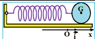
A l'équilibre, l'abscisse de G est  $x = 0$ . On écarte (S) de sa position d'équilibre stable dans le sens positif d'une distance  $d$  et on l'envoie à l'instant  $t = 0\text{s}$ , avec une **vitesse initiale** dans le sens négatif. La courbe ci-contre représente l'évolution temporelle de l'abscisse  $x(t)$  de G :
