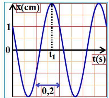
$x(t) = x_m \cos \left( \frac{2\pi}{T_0} t + \varphi \right)$  avec :  $T_0$  la période propre de l'oscillateur :
