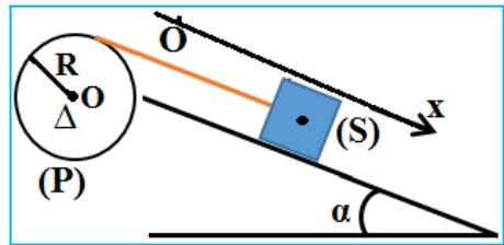
On roule sur (C) un fil (f) inextensible et de masse négligeable, à l'extrémité duquel est accroché un solide (S) de masse  $m = 300\text{g}$  qui peut glisser sans frottement sur un plan incliné d'un angle  $\alpha = 30^\circ$  avec l'horizontale.
