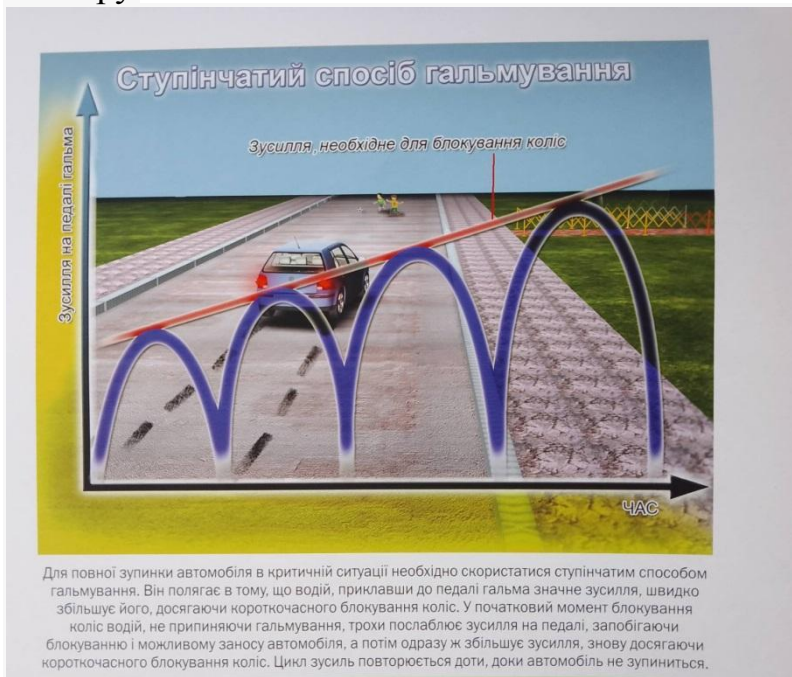
Рис.1.4. Ступінчатий спосіб гальмування
