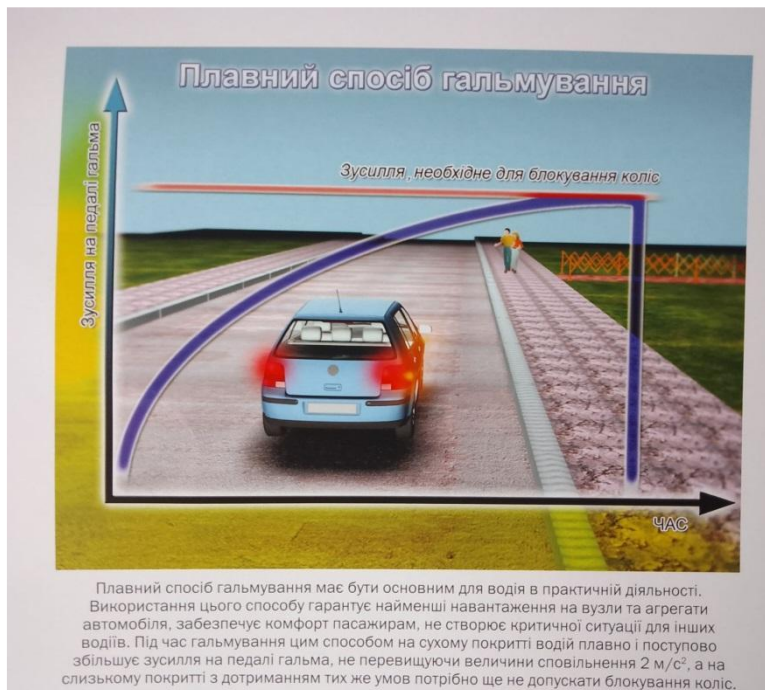
Рис.1.2. Плавний спосіб гальмування
