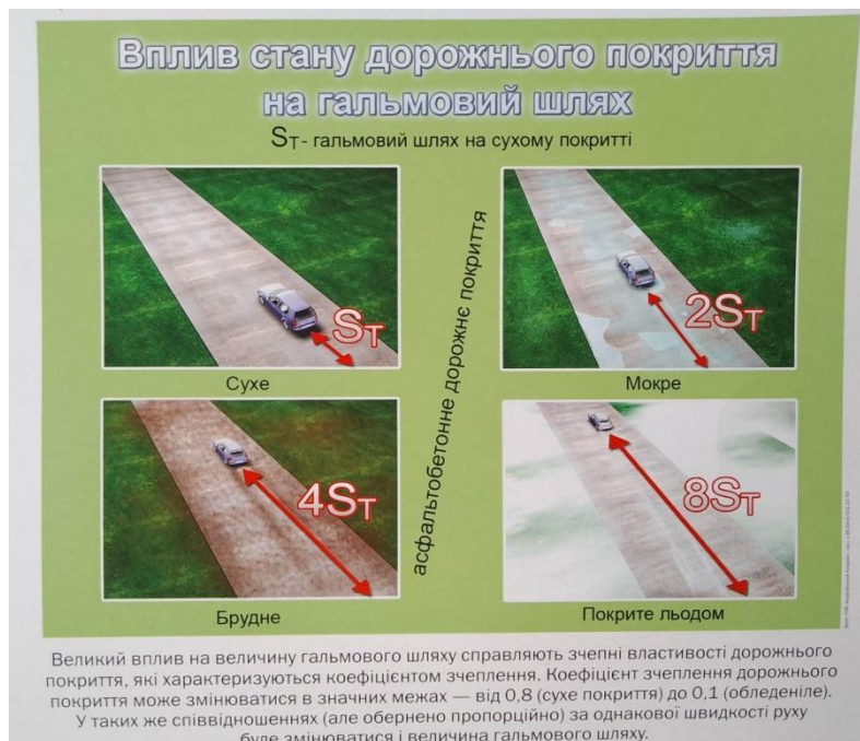
Рис.1.6. Вплив стану дорожнього покриття на гальмівний шлях
