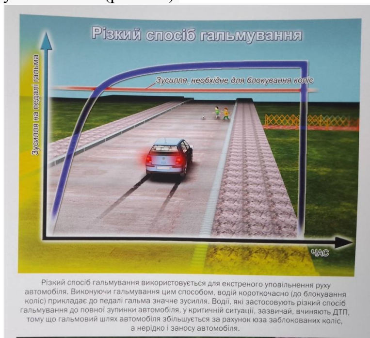
Рис.1.3. Різкий спосіб гальмування
