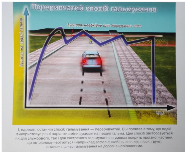
Рис.1.5. Переривчатий спосіб гальмування
