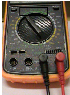
Figura SEQ Figura \* ARABIC 3: Foto de parte do seletor de um multímetro digital. Nela foi usado um retângulo preto para marcar a região em que o seletor deverá ser colocado a fim de medir a resistência elétrica da lâmpada.
