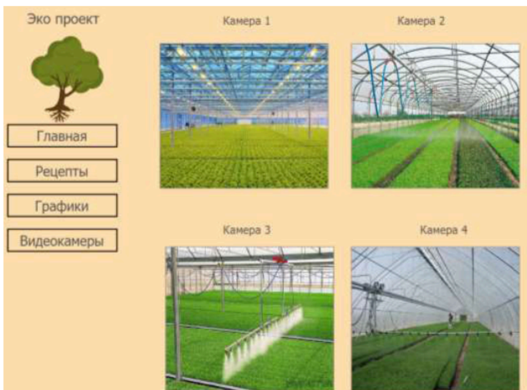
Рисунок 6 – Окно Видеокамеры SCADA-системы
