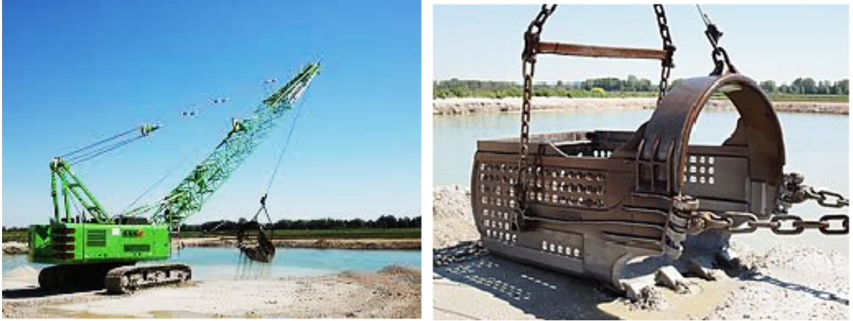
Рис.6. Драглайн-екскаватор з тросовим керуванням(зліва) ківш-драглайн (Справа)
