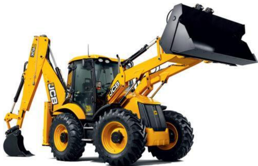
Рис. 5. Колісний екскаватор з прямим ківшом
