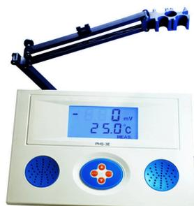
1. Conecte o plugue do sensor de pH (eletrodo) e de temperatura (termômetro) na parte de trás do equipamento e aperte o interruptor para ligá-lo. **Verifique se o aparelho está ligado na voltagem correta!**
