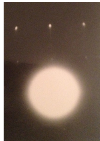
Figure 19 : Macro-diffraction par réflexion d'un échantillon monocristallin
