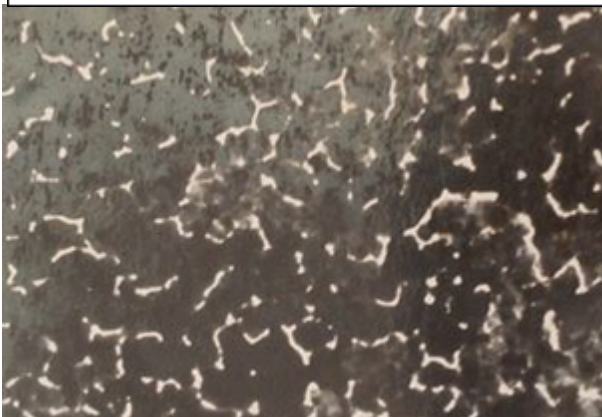
Figure 16 : Macro-diffraction par transmission d'un échantillon monocristallin maclé
