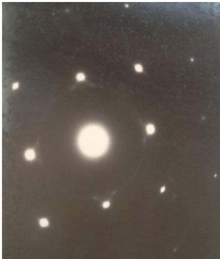
Figure 16 : Macro-diffraction par transmission d'un échantillon monocristallin maclé
