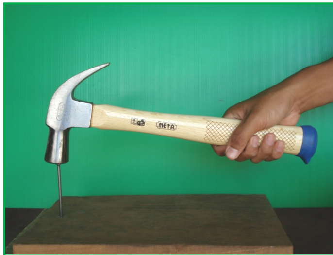
ภาพที่ 4 การตอกตะปู
