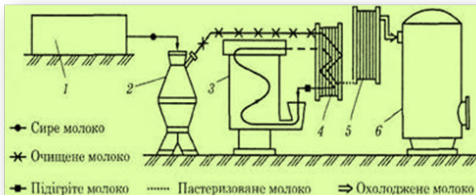
Рис. 9.1. Технологічна схема первинної обробки молока:
